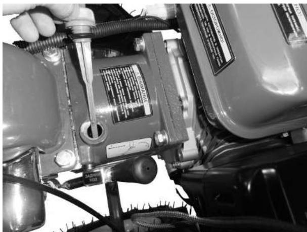
Рисунок 5 – Проверка уровня масла в корпусе редуктора
