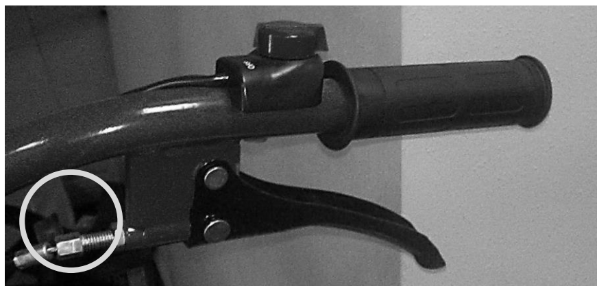
Рисунок 13 – Регулировка троса сцепления
